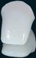
Das Ergebnis des Brennvorgangs bei 910 °C und 2 Minuten Haltezeit.
